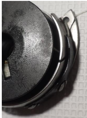
garen in sleuf naar voren tussen klemveer en door het gaatje omhoog
